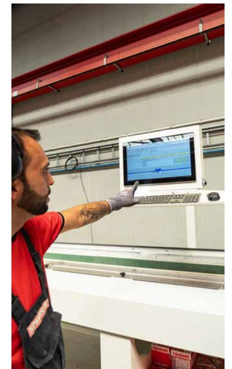
De aansturing van machines gaat ook via het platform BIM4Production, dit vraagt om goede samenwerking.
