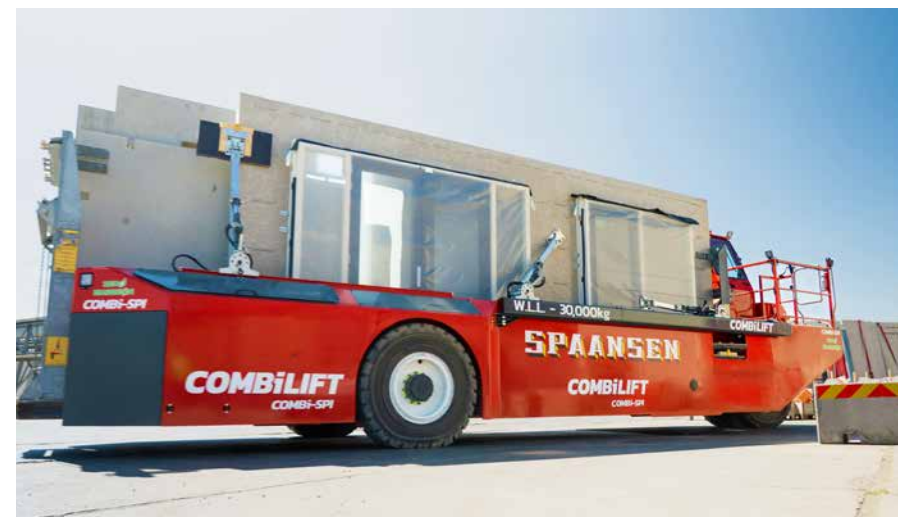
Transport van de kant en klare gevelsystemen.
